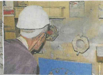
Un hublot permet de voir brûler les déchets à l'intérieur du four.
